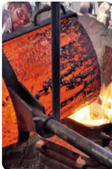
außenwand erreicht sind. Dann werden Kern und falsche Glocke in den ‚Mantel‘ verpackt. Auch der besteht aus Lehm und schmiegt sich in seiner Innenseite exakt an die Außenform der falschen Glocke an. Zum Schluss wird unter der Glockenform ein Feuer entzündet, der Lehm getrocknet, der Mantel abgehoben, die falsche Glocke zer schlagen und der Mantel wieder aufgesetzt.
